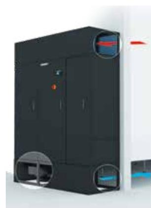
Исполнение для установки за пределами машинного зала, без фальшпола и подачи воздуха назад. В этом случае основание, имеющее фиксированную высоту 550 мм с боков закрыто панелями, а в тыльной части имеет распределительную решетку. Если при подаче воздуха назад нет системы воздуховодов, то наличие избыточного статического давления не обязательно.
